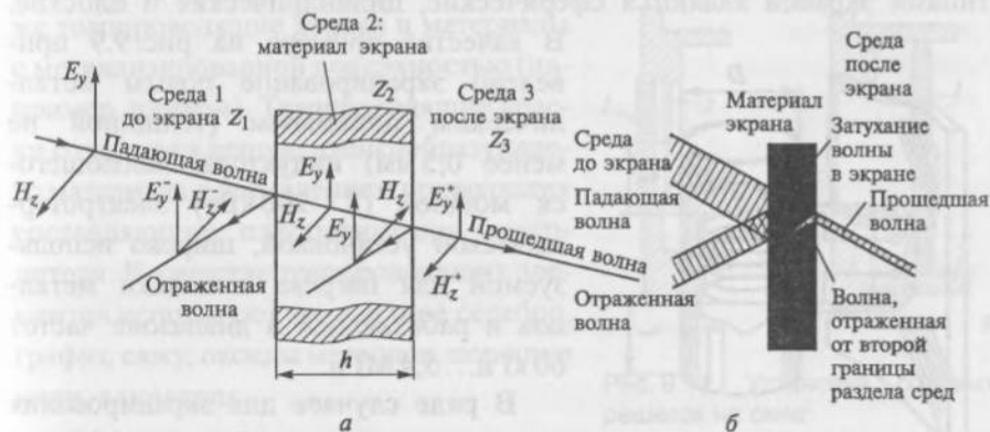
Рис. 9.8. Экранирование электромагнитных волн плоским экраном: а — прохождение волны сквозь экран; б — примерный амплитудный баланс
