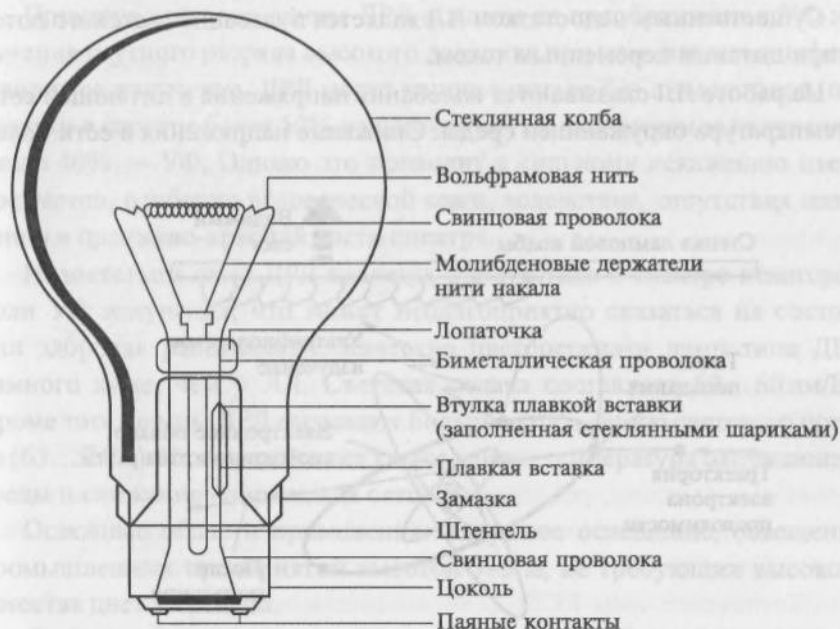
Рис. 6.5. Устройство лампы накаливания
