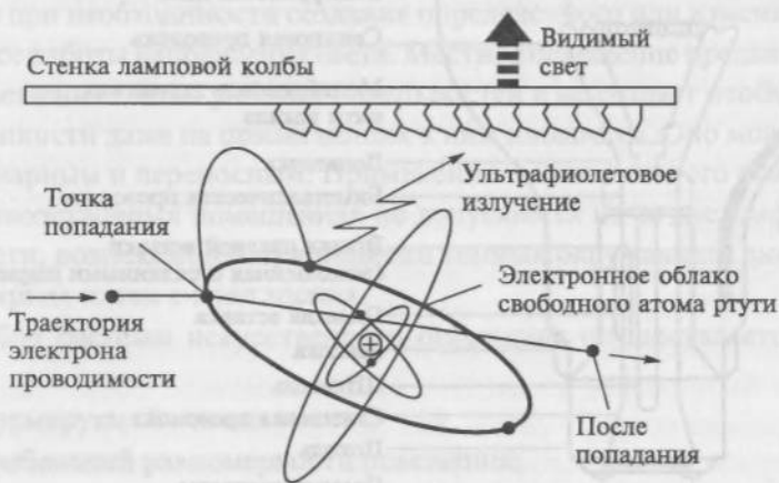
Рис. 6.6. Принцип люминесцентной лампы
